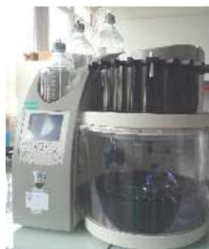
**Système automatisé d'extraction par solvant ASE 350 (Dionex)**
