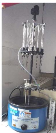
**Evaporateur sous jet d'azote N-EVAP 111 (Organomation)**
