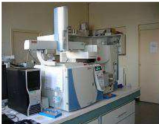
**Chromatographe en phase gazeuse Trace GC Ultra Spectromètre de masse TSQ Quantum XLS (Thermo Scientific)**
