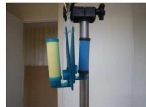
Radiello® est l'appellation commerciale d'un tube à diffusion radiale. Les principaux composants d'un tel tube sont la cartouche adsorbante, le corps diffusif et éventuellement la plaque de support. La cartouche adsorbante ainsi que le corps diffusif sont spécifiques à la famille des composés gazeux étudiée.
