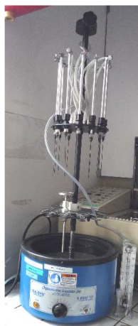
Evaporateur sous jet d'azote N-EVAP 111 (Organomation)
