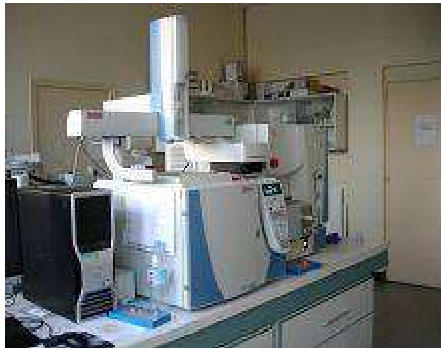
Chromatographe en phase gazeuse TRACE GC Ultra muni d'un injecteur PTV et d'une plateforme d'INJECTION automatique TRIPLUS AUTOSAMPLER (Thermo Scientific) - SPECTROMETRE DE MASSE EN TANDEM DE TYPE TRIPLE QUADRIPOLE TSQ QUANTUM GC (Thermo Scientific)
