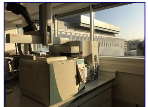
Système de chromatographie en phase gazeuse couplée à la spectrométrie de masse en tandem pour l'analyse des micropolluants organiques, LERES
